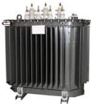
Трехфазные масляные трансформаторы ТМГСУ для четырехпроводных сетей 0,38 кВ с однофазной или смешанной нагрузкой со схемой соединения обмоток у/ун и специальным симметрирующим устройством (СУ).
