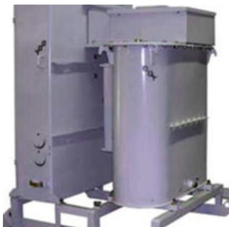
Трехфазный масляный трансформатор ТМТО80/0,38 предназначен для преобразования электроэнергии в составе устройств термической обработки бетона и грунта, питания электроинструмента и временного освещения в условиях умеренного климата. Рабочая температура окружающего воздуха от минус 45оС до плюс 10оС.
