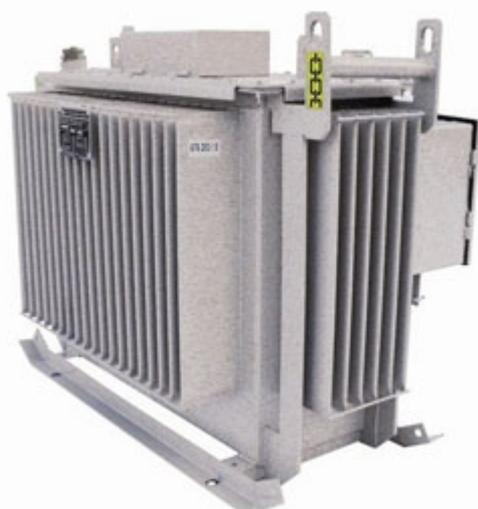
Трехфазные масляные трансформаторы ТМПН, ТМПНГ первичным напряжением 0,38 кВ и первичным напряжением 6 (10) кВ предназначены для питания погружных электродвигателей добычи нефти (ПЭД). Отличительной особенностью трансформаторов ТМПН, ТМПНГ от других типов трансформаторов является, то, что они имеют широкий диапазон (до 36 ступеней) регулирования выходного напряжения и специфическую внешнюю характеристику.
